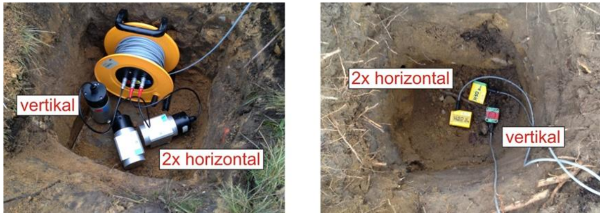
Bild 4: Beispielhafte Darstellung der 3-D Messpunkte (links: Seismometer, rechts: Schwinggeschwindigkeitssensor)
